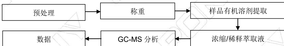
邻苯二甲酸酯类检测流程图
